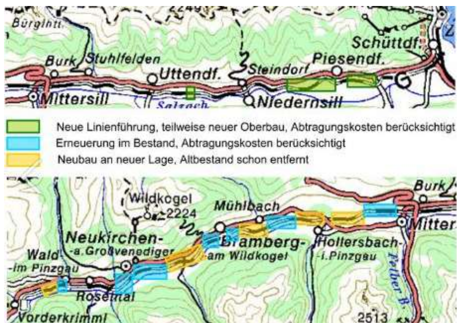
Abb. 29: Wiederaufbau der Pinzgauer Lokalbahn 66
